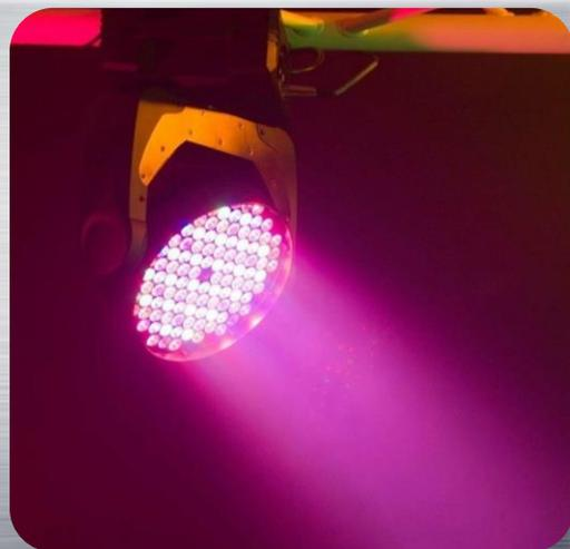
Цветная светодиодная панель с эффектом заливки и стробоскопа
